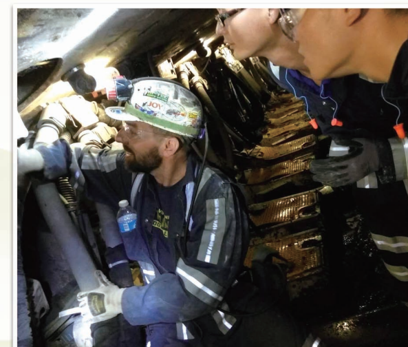
长壁工作面探讨液压支架工艺参数
