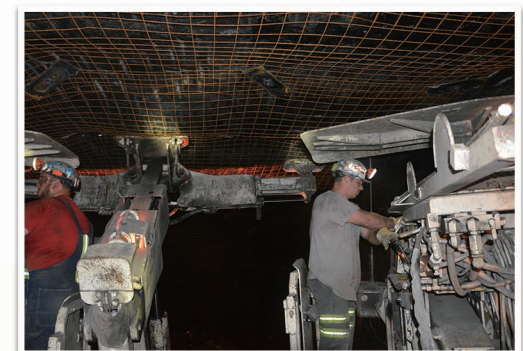
房柱式工作面安装锚杆
